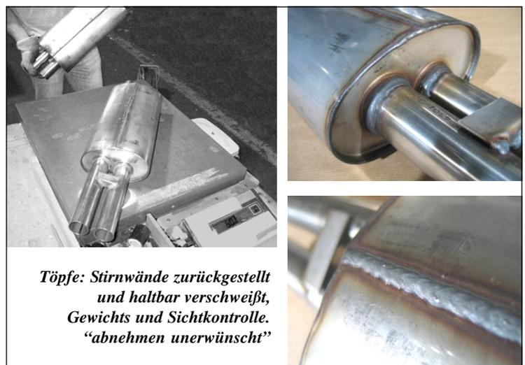
**Töpfe: Stirnwände zurückgestellt und haltbar verschweißt, Gewichts und Sichtkontrolle. "abnehmen unerwünscht"**
