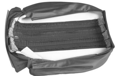
**Hochwertige und originalgetreue Verarbeitung:** Polstereinlagen der Sitzpfeifen gefüllt mit Filzen und Polsterschaum, in Stofflage fixiert, Oberfläche mit originalgetreuer Perforation (Flechtnarbe, siehe Bild), Kantenversteifung für die Befestigung, Keder aus Echtleder. Farben angelehnt an die damalige Mercedes-Farbpalette, aber nicht identisch.
