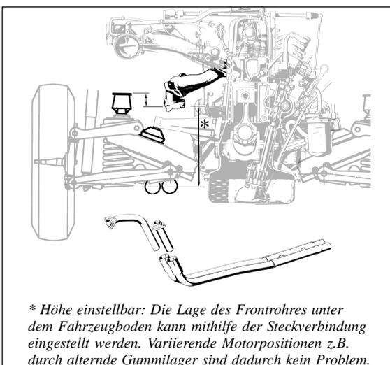
\* Höhe einstellbar: Die Lage des Frontrrohres unter dem Fahrzeugboden kann mithilfe der Steckverbindung eingestellt werden. Variierende Motorpositionen z.B. durch alternde Gummilager sind dadurch kein Problem.
