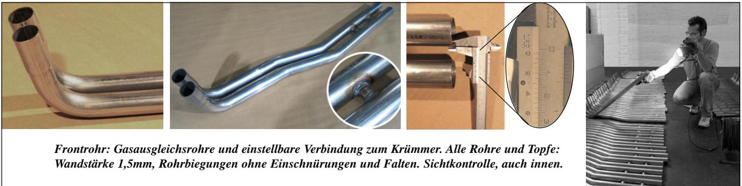
**Frontrrohr: Gasausgleichsrohre und einstellbare Verbindung zum Krümmer. Alle Rohre und Topfe: Wandstärke 1,5mm, Rohrbiegungen ohne Einschnürungen und Falten. Sichtkontrolle, auch innen.**
