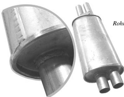
Eberspächer, wenn es original sein soll: Rohrstützen für geschweißte Montage, Prägung mit KBA-Nummer und Fahrzeugbezeichnung. In aktueller Produktion Zink-Alu beschichtet (ehemals schwarz).
